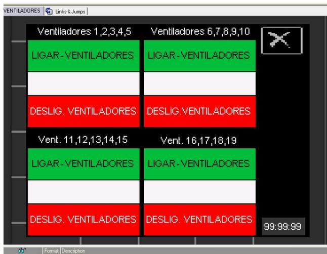
Pressionando o botão ventiladores na tela de Menu, vai aparecer esta tela do lado, O operador vai ligar e desligar os ventiladores e exaustores quando for necessário.
